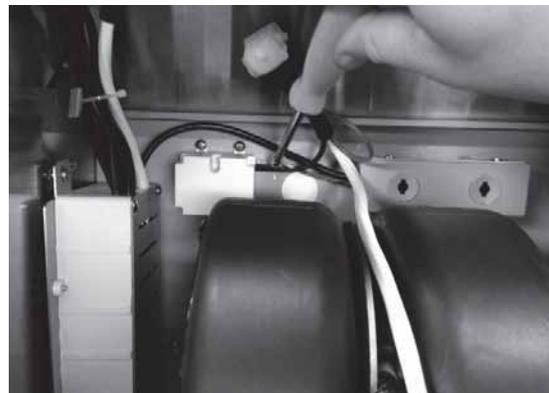
4. Fixez le fil de mise à la terre du boîtier du condensateur à l'écrou situé à côté du boîtier.
