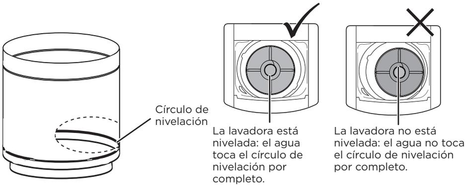
3. Si la lavadora no está nivelada, inclínela con cuidado lo suficiente para ajustar las patas niveladoras en la parte inferior de la lavadora. Extienda las patas tanto como sea necesario. Si se extienden demasiado, la lavadora puede vibrar.
