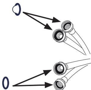
2. Apriete los accesorios de la manguera y el grifo a mano hasta que estén ajustados, luego apriételos dos tercios de un giro adicional con una pinza o una llave inglesa. Tire de las mangueras de suministro de agua hacia abajo para asegurar que estén conectadas de forma segura.
