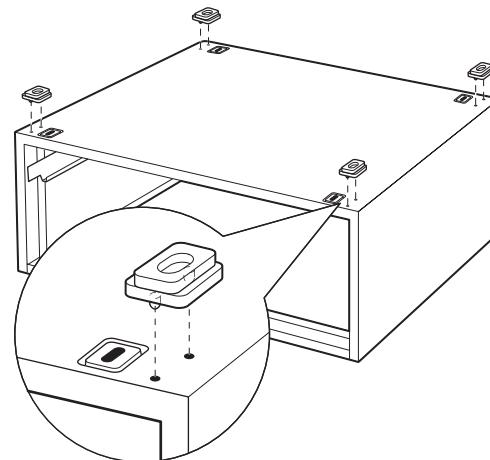
REMARQUE : les coussinets de support doivent être installés seulement sur la sécheuse. N'INSTALLEZ PAS CES COUSSINETS SUR LE PIÉDESTAL DE LA LAVEUSE.
