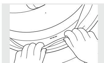
3. Cuando haya terminado de limpiar la junta de la puerta, quite las manos y la junta volverá a la posición de funcionamiento.
