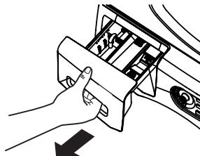
Tal vez vea agua en la gaveta de dispensadores al final del ciclo. Esto se debe a la acción de descarga/sifón y es parte del funcionamiento normal de la lavadora.
