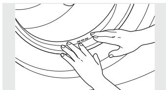
2. Mientras presiona hacia abajo la junta de la puerta, inspeccione el interior de la junta empujándola hacia abajo con los dedos. Retire todos los objetos extraños que estén atrapados dentro de esta junta. Asegúrese de que no quede nada que bloquee los orificios debajo de la junta.
