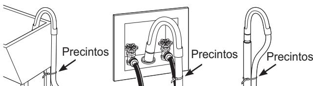
**NOTA:** Si coloca la manguera de desagüe demasiado abajo del tubo de desagüe, se puede producir una acción de sifón. Dentro del tubo de desagüe, no debería haber más de 7 pulgadas (17,78 cm) de manguera. Debe haber una separación de aire alrededor de la manguera de desagüe. Un accesorio de ajuste también puede provocar una acción de sifón.
