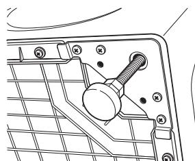
**NOTA: Mantenga la extensión de la pata al mínimo para evitar el** exceso de vibración. Cuanto más hacia afuera se extiendan las patas, más vibrará la lavadora.
