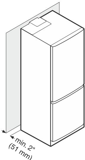
Si la distance entre l'arrière de l'appareil et le mur est inférieur à 2 pouces (51 mm), la consommation énergétique peut augmentée.
