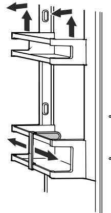
Mueva el soporte de botellas hasta la posición que desee. Sujete siempre la parte delantera al moverlo.
