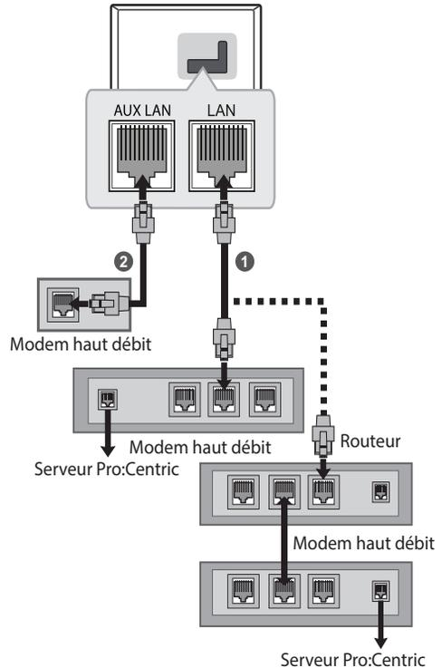
**1** Raccordez le port de **LAN** du modem ou du routeur au port de **LAN** du téléviseur.
