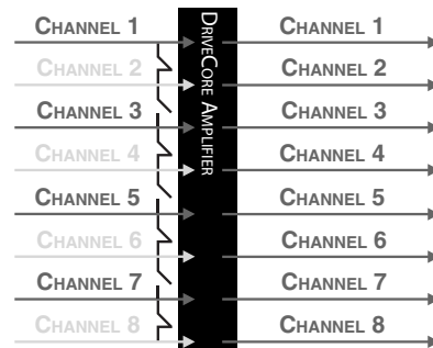
Abb. 4.6.5 Vier-Kanal zu Acht-Kanal-Routing
