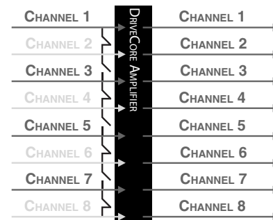
Schéma 4.6.5 Routage quatre canaux sur huit canaux
