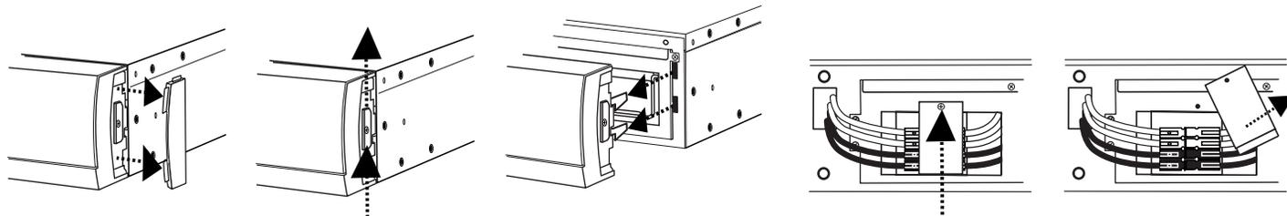
1. Retirer le panneau avant. Retirer les capuchons en caoutchouc et tirer sur le mécanisme de verrouillage. Une fois que le mécanisme de verrouillage s'arrête, retirer progressivement le panneau avant du F1500-UPS.
