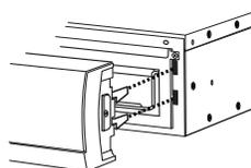
4. Aligner avec précaution le connecteur du panneau avant et les attaches avec le F1500-UPS.
