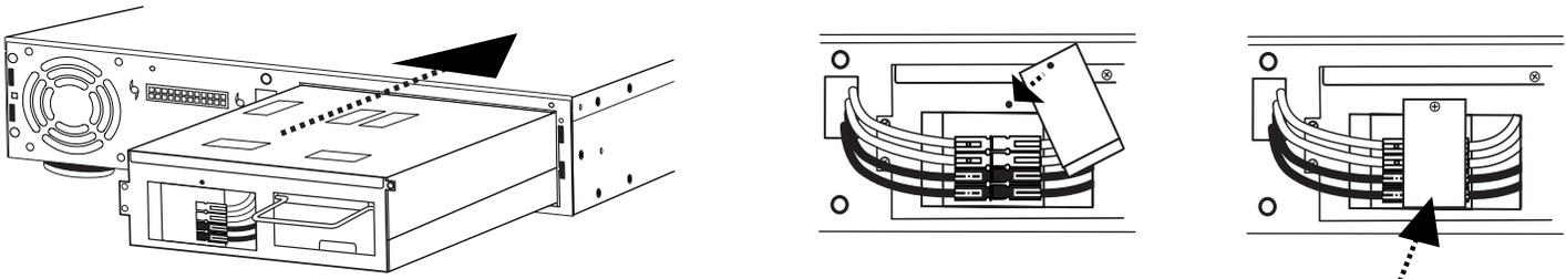
5. Instale el nuevo pack de batería en la unidad. **NO INTENTE REEMPLAZAR LAS BATERÍAS EN EL PACK DE BATERÍA ORIGINAL UNA INSTALACIÓN INADECUADA PUEDE CAUSAR UN INCENDIO O PÉRDIDA DE LA BATERÍA.**
