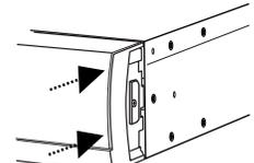
5. Presione gradualmente en los extremos derecho e izquierdo del panel frontal hasta que oiga el "clic" de los pestillos.
