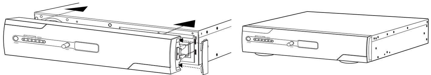
7. Instale nuevamente el panel frontal según las instrucciones de instalación del panel frontal.
