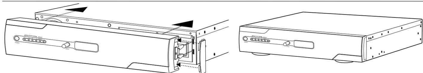
7. Remettre le panneau avant conformément aux instructions d'installation du panneau avant.
