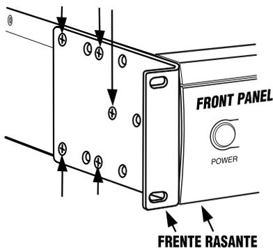
**OPCIÓN 2 - PARA MONTAR PARA EL RETIRO FÁCIL DEL PANEL DE DELANTE**
