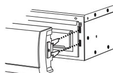
4. Alinear cuidadosamente el conector del panel frontal y los pestillos con el F1500-UPS
