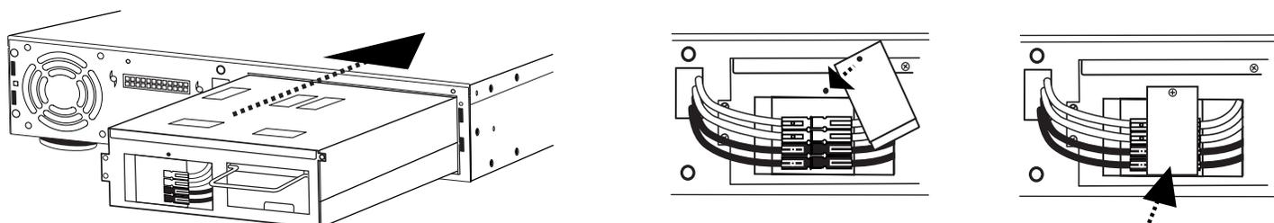
5. Installer le nouveau bloc de batteries dans l'appareil. **NE PAS TENTER DE REMPLACER DES BATTERIES DANS LE BLOC DE BATTERIES ORIGINAL. UNE MAUVAISE INSTALLATION PEUT ENTRAÎNER UN INCENDIE OU UNE FUITE DE BATTERIE.**
