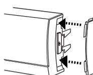
3. (Opcional) Instale las tapas de goma laterales suministradas a los costados del panel frontal. Coloque el borde curvado de la tapa lateral en las ranuras de unión del panel frontal.
