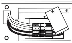
2. Verifique que los conectores de batería se encuentren conectados; los rojos con los rojos y los negros con los negros. Si no se encuentran conectados, realice los pasos 2 y 6 de la sección REEMPLAZO DE BATERÍA
