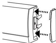
3. (Facultatif) Installer les capuchons en caoutchouc sur les côtés du panneau avant. Pousser le bord arrondi du capuchon dans les fentes d'appui du panneau avant.
