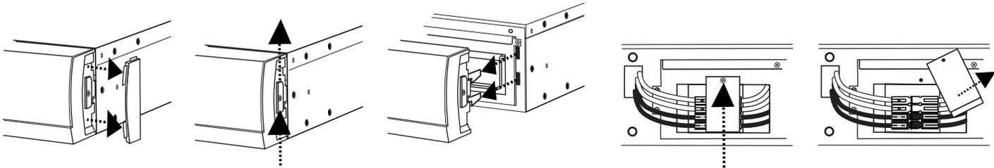
1. Quite el panel frontal. Quite las tapas de goma laterales y tire hacia arriba el mecanismo de los pestillos. Una vez que se detenga el mecanismo de los pestillos, quite lentamente el panel frontal del F1500-UPS.
