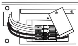
2. Vérifier que les raccords de la batterie sont connectés, rouge au rouge, noir au noir. S'ils ne sont pas connectés, réaliser les étapes 2 à 6 de la section REMPLACEMENT DE LA BATTERIE.
