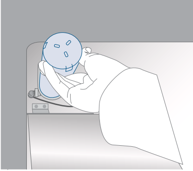
Remplacement du filtre
